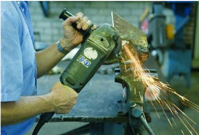
Figuur 3-21: Dikke platen bewerk je voor met een haakse slijper.
